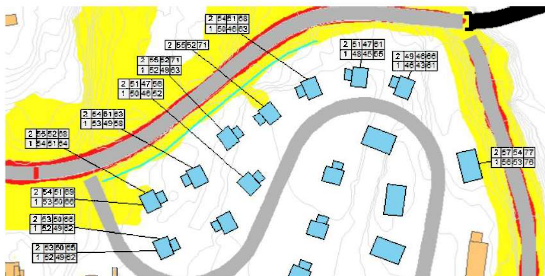
Figur 28. Alternativ 1: Støyskjerm på 1,5 meter langs Gravfossveien.
