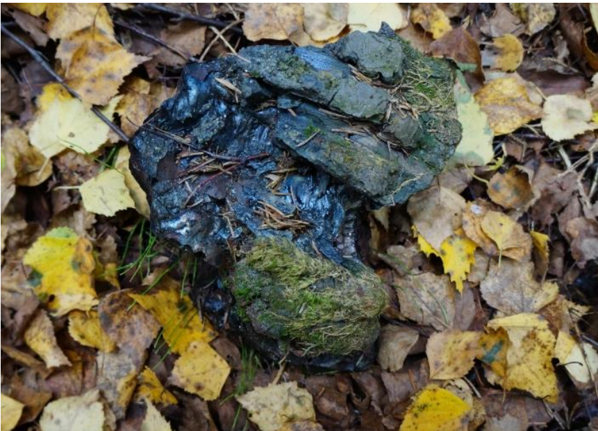
Figur 6: Eksempel på slagg fra jernvinneanlegg av den eldste typen, som var i bruk før år 700 e. Kr. Slaggklumpene fra denne ovnstypen er gjerne store og tunge med avtrykk etter veden som ble brukt til å fyre opp ovnene.
