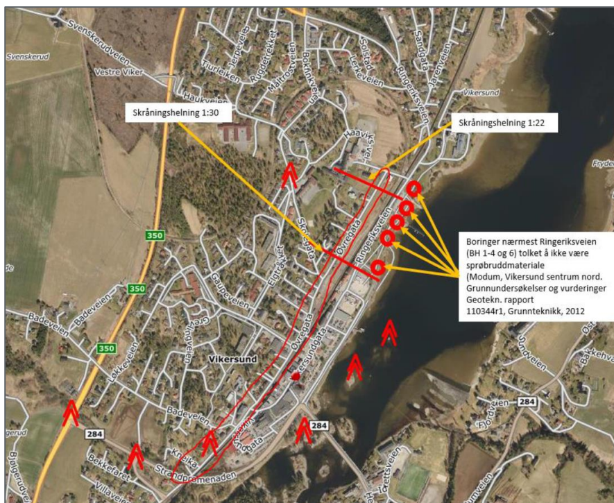
Figur 45: Markering av utvalgte steder med berg i dagen (røde hakker), skråningshelning og plassering av noen kjente borer.
